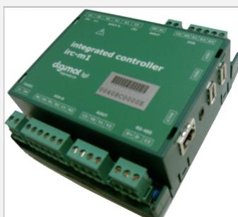
Régulateur autonome totalement programmable grâce à un puissant environnement de développement basé sur une technologie standardisée 6-1131.
